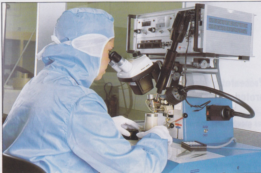
Isabelle Quenescourt réalise un câblage filaire 25 microns.
