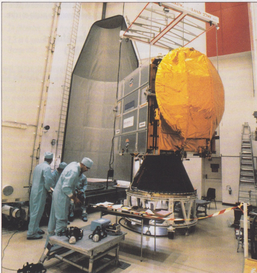
Mise sous coiffe de TELECOM 2A au bâtiment S3 du CSG.
