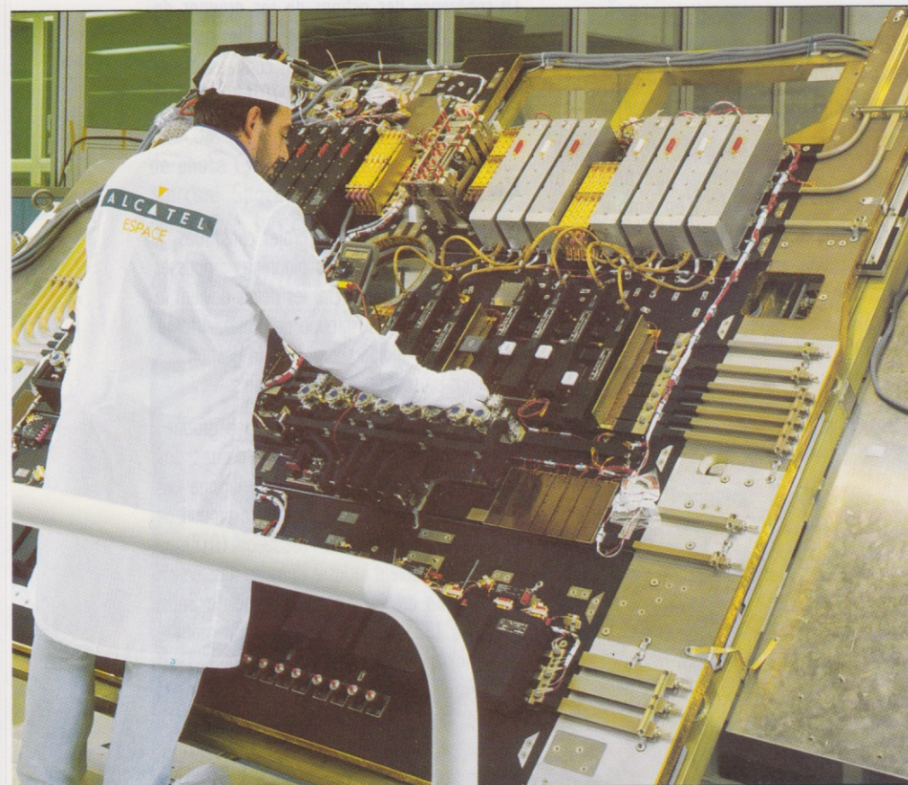
Mise en place d'équipements sur l'un des panneaux de TELECOM 2A.
