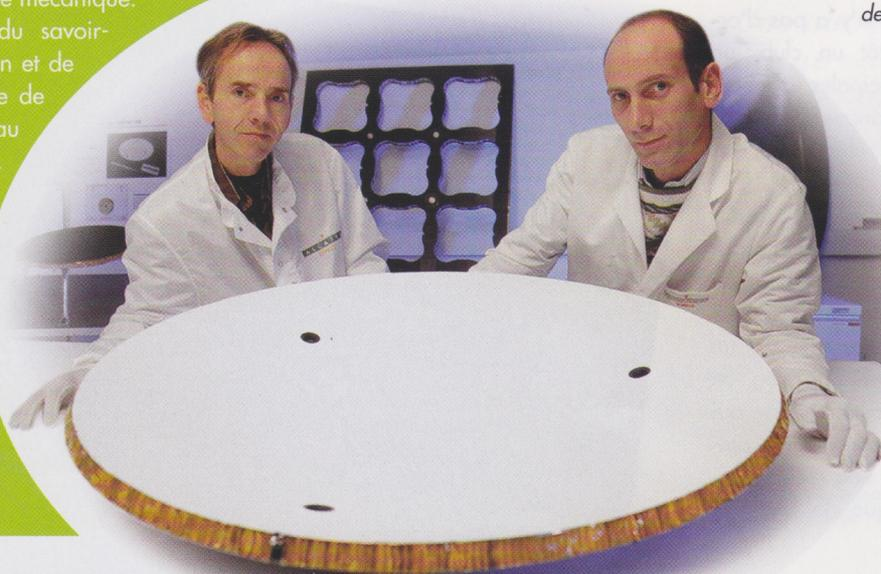
La réalisation d'un réflecteur d'antenne, c'est aussi un "tour de main" pour aboutir à la qualité et à une précision de forme de 0,05 mm ! Ici, une réalisation d'Alain Delarue et Ian Howes
