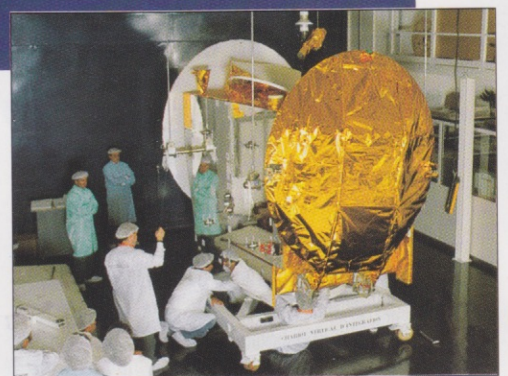
Sortie du satellite TELECOM 2 de son container dans le sas d'entrée de l'intégration.
