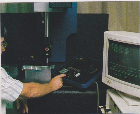
Contrôle automatique d'un diviseur à 3 voies d'EUTELSAT II.
