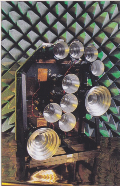
Source d'antenne passive TELECOM 2 (4 GHz).
