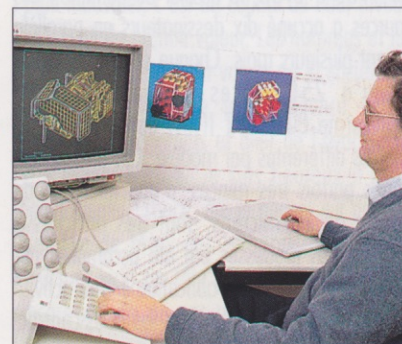
A. Gérard à un poste de CAO pour la conception de l'antenne EUTELSAT II.
