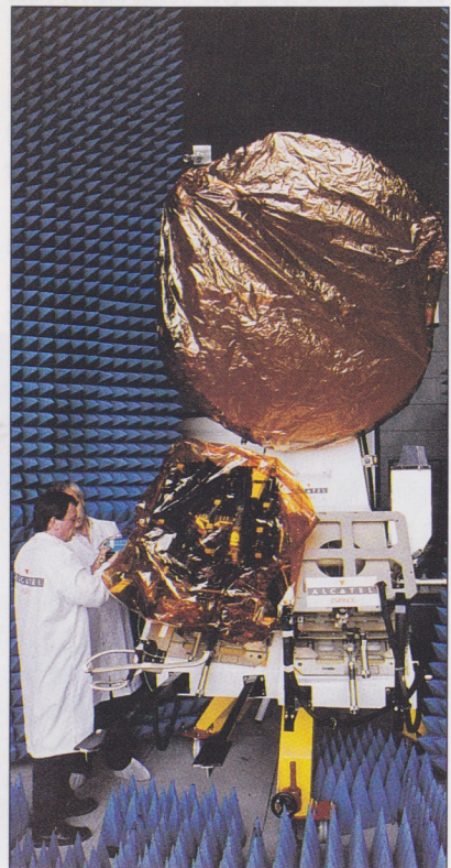
Antenne EUTELSAT II en chambre anéchoïque.
