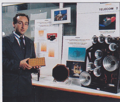
G. Duret présente, à des visiteurs, un sous-réseau d'éléments imprimés en bande Ku (12 GHz).
